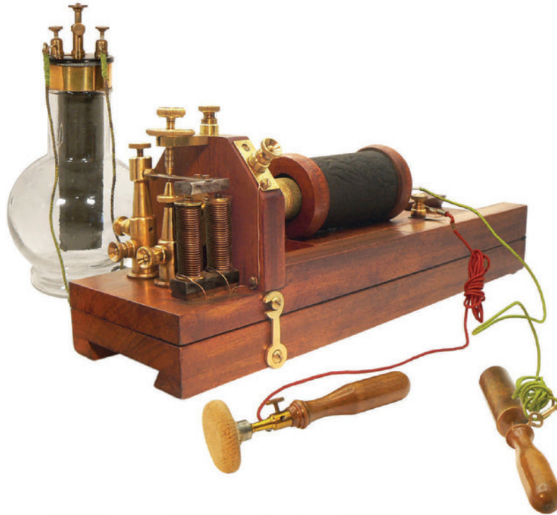
Figura 4. Máquina de Joseph Charrière para electroterapia, semejante a la usada por Duchenne de Boulogne en el tratamiento de enfermedades neuromusculares. © Le Compendium. Albert Balasse.
